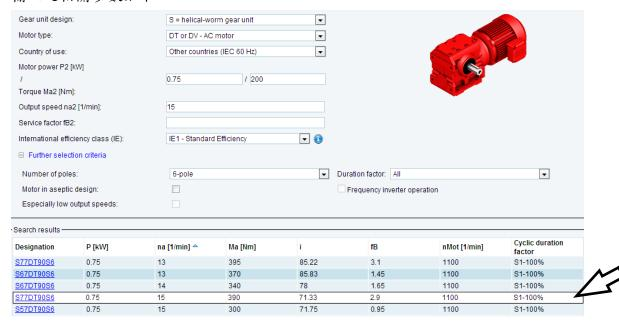
選取的主要標準為其輸出轉速(15*rpm*),因而選用符合之電動機,詳細型錄表內容於附錄中。
