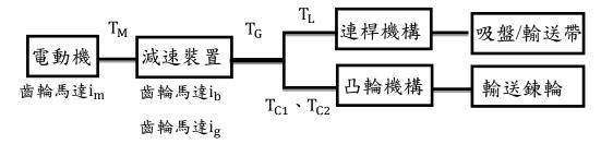
電動機所需動力可由凸輪機構所需扭矩(23.82 + 4.118(Nm))、連桿機構所需 扭矩(1971.5(Nm))、減速裝置減速比計算得出,若假設力矩傳動至連桿與凸輪 機構過程中毫無其他損耗,則
